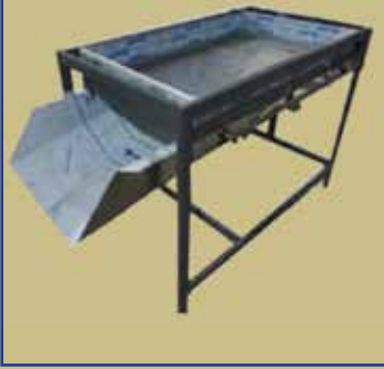
غريال - صامت مصنوع من الستاليس ستيل 316 يستعمل لغرلة المواد الجافة
