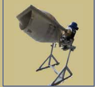
محامص - خلاط - ومعقم كهربائي يستخدم لخلط المكسرات ومزود بشفاط لتفريغ الهواء الساخن
